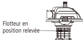
**IMPORTANT:** Afin d'éviter d'endommager l'aspirateur, ne faites pas fonctionner le moteur lorsque le flotteur est soulevé.
