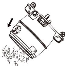
3. Les liquides peuvent être vidés par le drain du réservoir. Pour vider l'appareil, éteignez l'appareil et retirez la fiche de la prise murale. Retirez le bouchon de vidange et déposez les résidus liquides dans un drain approprié. Une fois le réservoir vide, remettez le bouchon de vidange dans sa position d'origine. Pour continuer à l'utiliser, branchez le cordon dans la prise murale et allumez l'appareil.
