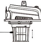
**IMPORTANT:** Afin d'éviter d'endommager l'aspirateur, ne faites pas fonctionner le moteur lorsque le flotteur est soulevé.
