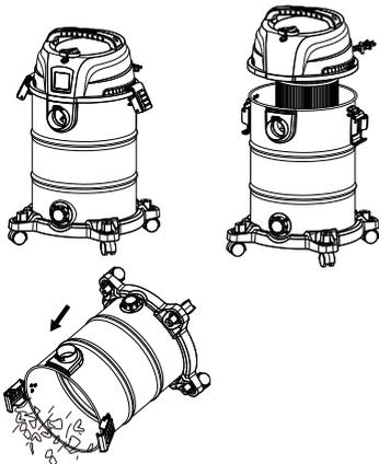
3. Les liquides peuvent être vidés par le drain du réservoir. Pour vider l'appareil, éteignez l'appareil et retirez la fiche de la prise murale. Retirez le bouchon de vidange et déposez les résidus liquides dans un drain approprié. Une fois le réservoir vide, remettez le bouchon de vidange dans sa position d'origine. Pour continuer à l'utiliser, branchez le cordon dans la prise murale et allumez l'appareil.
