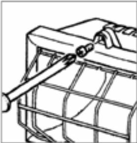
1. Dévissez la vis sur le dessus de la lampe pour dégager la grille de protection, le cadre avant et la vitre.
