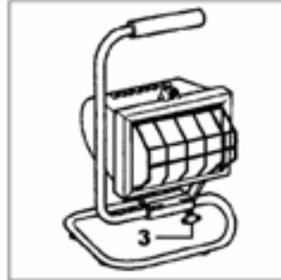
2. L'angle de la lampe peut être modifié simplement en dévissant le boulon de réglage (3), en inclinant la lampe à l'aide de la poignée, puis en resserrant le boulon.
