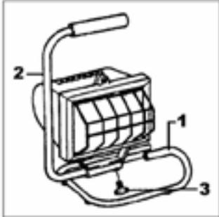
1. Insérez l'extrémité de la base (1) dans l'autre extrémité du tube. Réglez la lampe à l'angle désiré à l'aide de la poignée (2). Insérez et serrez le boulon de réglage de l'angle (3).
